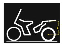
d) Dann wiederholen Sie die gleiche Messung mit dem Fahrer und der Ausrüstung auf dem Motorrad. Es ist wichtig, dass der Fahrer die richtige Sitzposition einhält.
