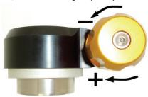
3) Elektrische Federvorspannung Drücken Sie den Knopf auf dem Bedienfeld. Drücken Sie "hard", um die Vorspannung zu erhöhen und drücken Sie "soft", um sie zu verringern (siehe Bild).
