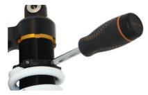
2) Hydraulische Federvorspannung Drehen Sie das Hydraulik-Einstellrad, um die Vorspannung einzustellen. Drehen Sie im Uhrzeigersinn, um die Vorspannung zu erhöhen, drehen Sie gegen den Uhrzeigersinn, um sie zu verringern (s. Bild).
