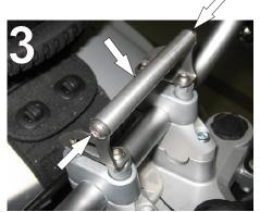
3.) Halterohr zwischen Halter links und Halter rechts positionieren und mit 2 x Linsenkopfschraube M6x16 A2 verschrauben! (Bild3)
