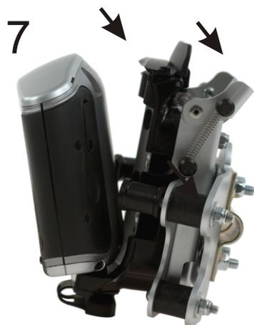
2. Verriegelungen an der Lenkerhalterung und am Kunststoffhalter des ZUMO Öffnen! ZUMO zuerst unten in die Halterung einsetzen (Bild 7)
