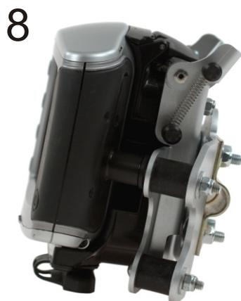
3. ZUMO ganz einrasten und die Verriegelung am Kunststoffhalter schließen! (Bild 8)
