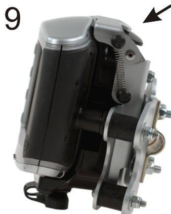
4. Verriegelung an der Lenkerhalterung schließen! (Bild 9)
