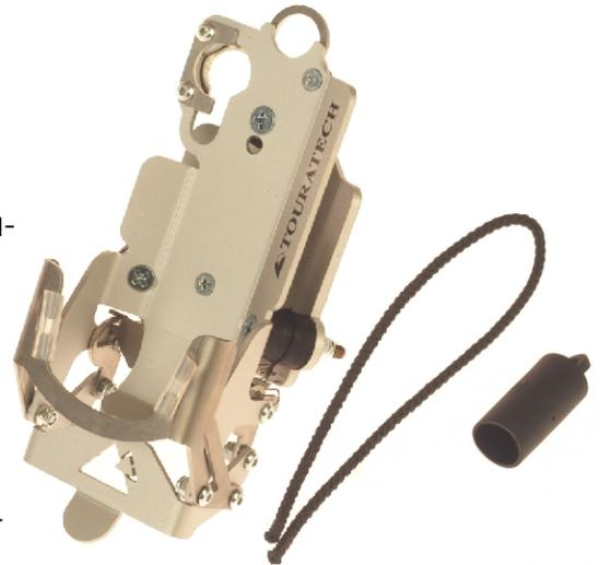
Zum Einsetzen des Geräts müssen Sie den Betätigungshebel hinunter drücken und den schwarzen Kunststoffknopf aus dem Lieferumfang des Gerätes installiert haben.
